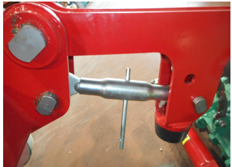
Réglage du poignet par vérin manuel
