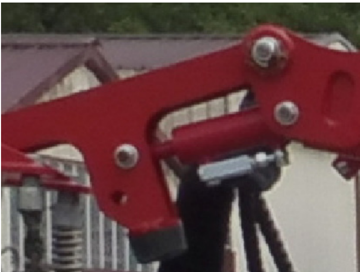
Réglage du « poignet » par vérin hydraulique
